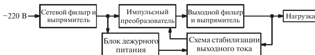
Рис. 2. Упрощенная структура компьютерного блока питания.
