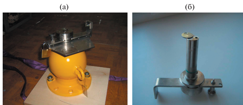
Рис. 2. Блок источника излучения (а) и затвор блока источника излучения (б).
