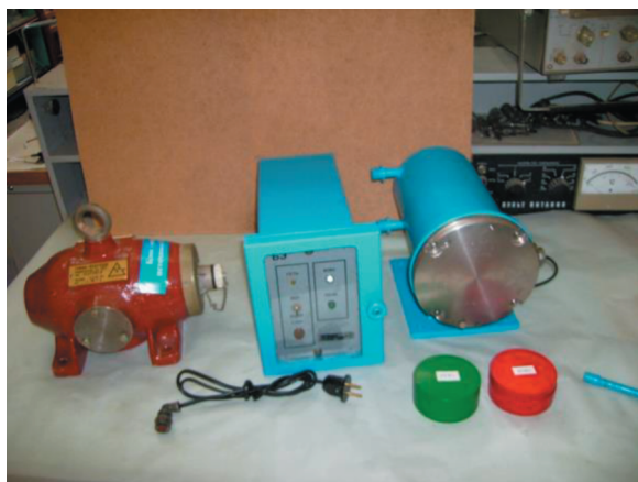
Рис. 1. Радиоизотопный индикатор уровня нефтяного кокса: блок источников излучения (БГИ-45), электронный распределительный блок, блок детектирования, имитаторы пены и кокса.
