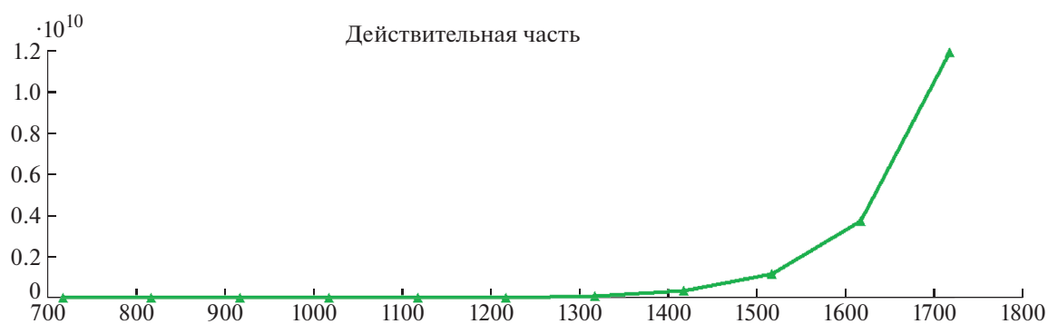
Рис. 10. Зависимость внешней добротности основной волны от длины волновода.
