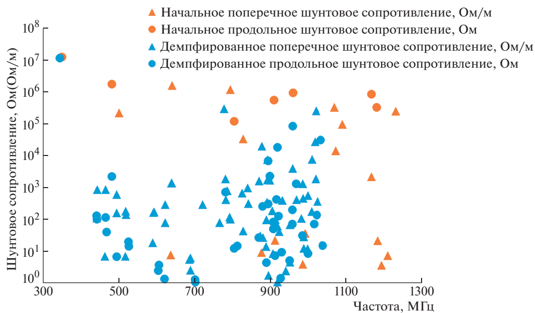
Рис. 11. Сравнение продольного и поперечного шунтового сопротивления для монопольных и поперечных видов колебаний от частоты для ускоряющего резонатора на 350 МГц без устройств вывода ВВТ и с устройствами вывода ВВТ.
