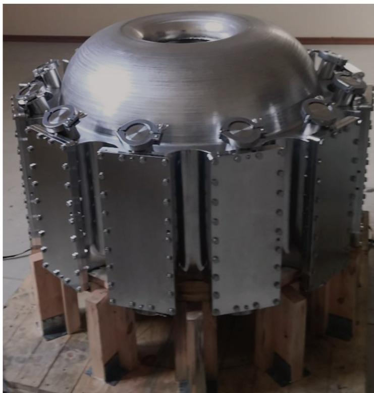
Рис. 7. Фотография вакуумной камеры токамака МИФИСТ-1.
