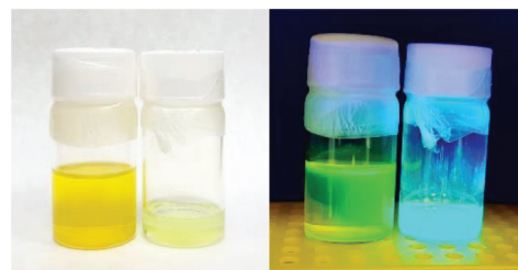
Рис. 2. Внешний вид растворов ПНК состава CsPbBr 3 , полученных в синтезе с применением ТДФК в качестве поверхностных лигандов при обычном освещении (слева) и под УФ-освещением (справа). Левая виала — ПНК без дополнительной очистки методом ГПХ; правая виала — ПНК с дополнительной очисткой.
