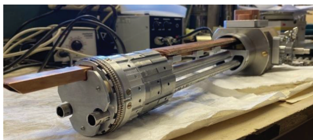
Рис. 7. Узел инжекции источника DECRI5-5M: 1, biased-электрод; 2, волновод; 3, охлаждение волновода; 4, изолятор; 5, вставка из мягкого железа; 6, держатель.
