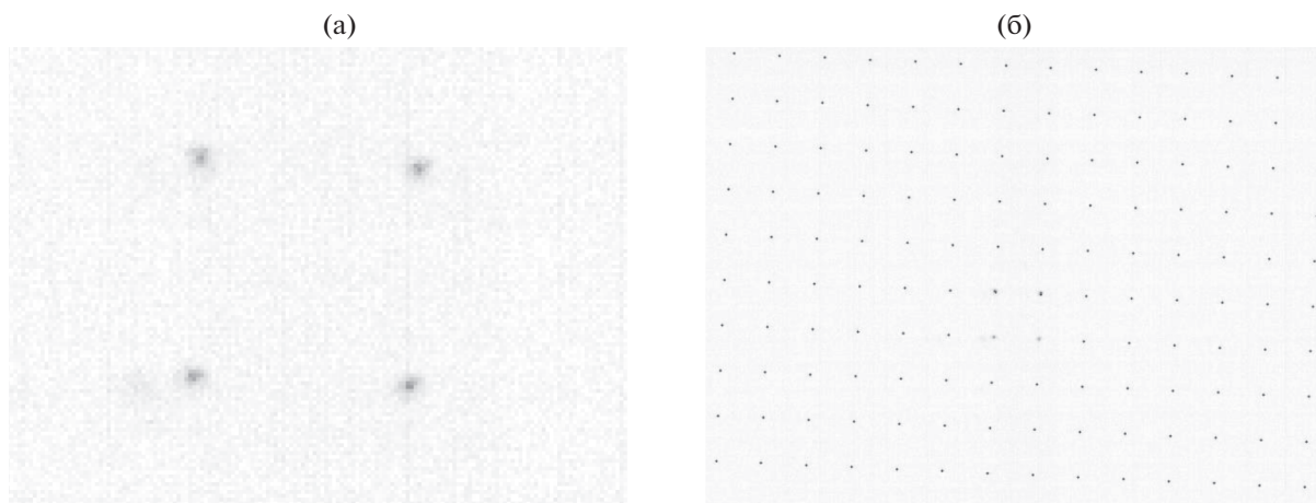
Рис. 3. Восстановление координат отверстий маски: изображение отверстий маски в лучах плазмы (а); восстановленные координаты отверстий (б).
