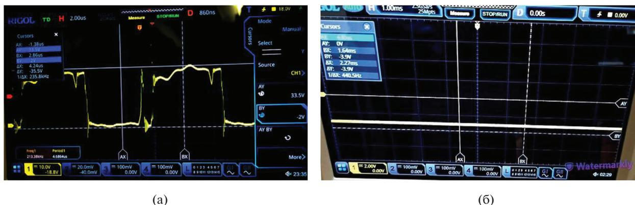
Рис. 7. Зависимость напряжения от времени: (а) на первичной обмотке на холостом ходу; (б) половина максимального напряжения на холостом ходу.
