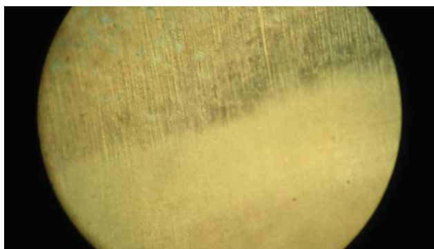
Рис. 5. Поверхность меди после обработки в случае раствора глицерина.
