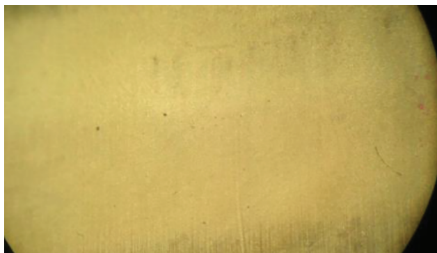
Рис. 4. Поверхность меди после обработки в случае раствора \text{NH}_4\text{NO}_3 .
