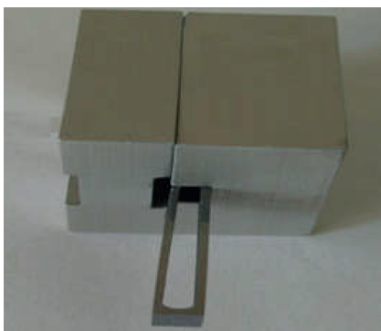
Рис. 1. Кристаллический дефлектор “О-типа” (размеры: длина 5 мм, высота 5 мм, толщина 0.7 мм, угол изгиба 2 мрад.).
