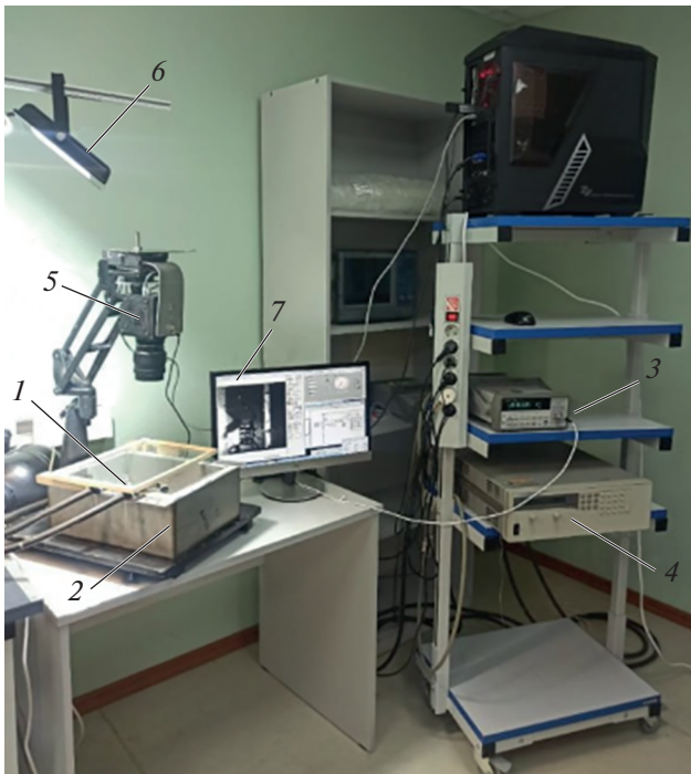
Рис. 4. Внешний вид экспериментального стенда: 1 – ВТСП лента; 2 – криостат с жидким азотом; 3 – импульсный источник тока; 4 – нановольтметр; 5 – высокоскоростная камера Evercam; 6 – осветительный прожектор; 7 – контрольный монитор.
