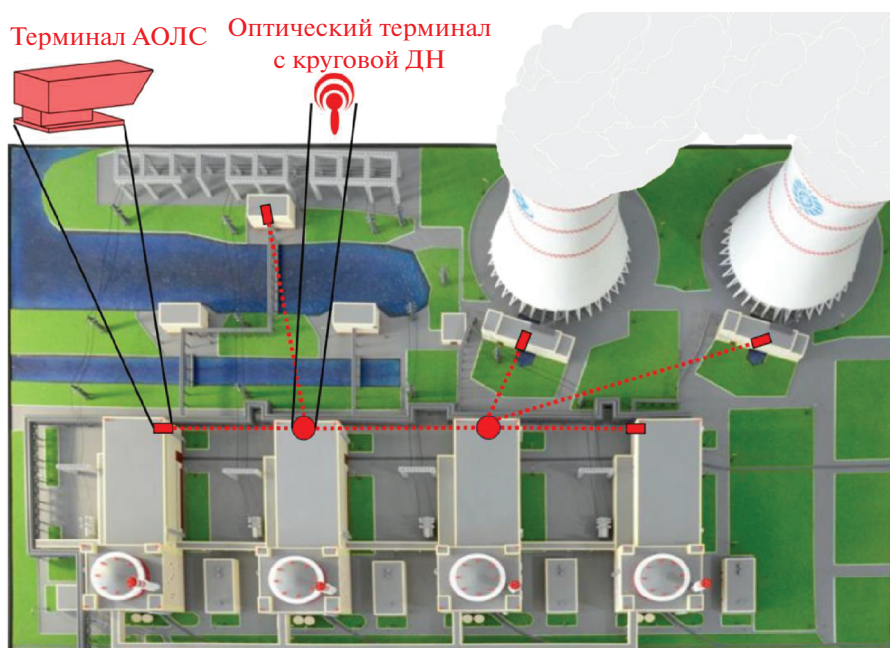
Рис. 2. Концепция применения АОЛС совместно с терминалами круговой диаграммы направленности на макете ОИАЭ.
