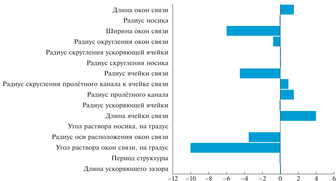
Рис. 4. Влияние изменения на 0.1 мм геометрических размеров модели на частоту поля в ячейках связи, МГц.
