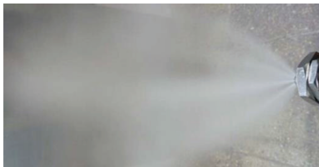
Рис. 9. Вид факела распыла двухфазной форсункой газо-капельного потока при рассчитанных режимах работы газовой и водяной систем стенда.
