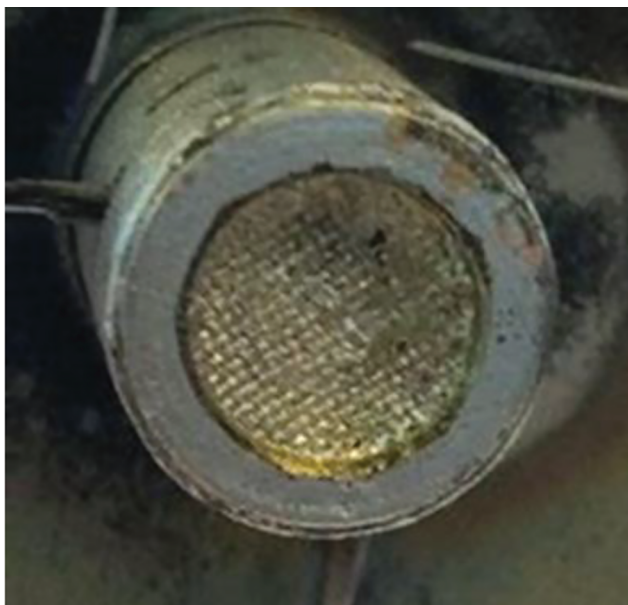
Рис. 1. Литиевая КПС после воздействия дейтериевой плазмы.
