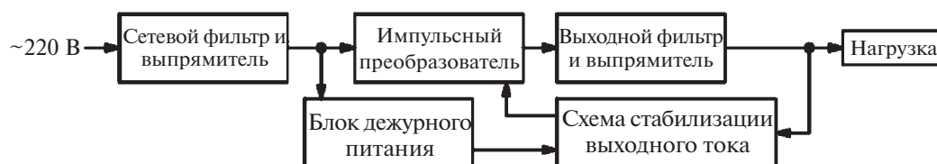
Рис. 2. Упрощенная структура компьютерного блока питания.
