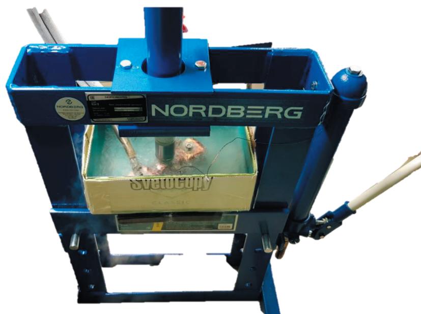
Рис. 2. Внешний вид установки для измерения критического тока ВТСП лент под давлением.
