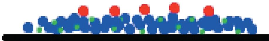
Рис. 2. Схема насыпки порошка Ti(20%)/BN-(карборан сверху).
