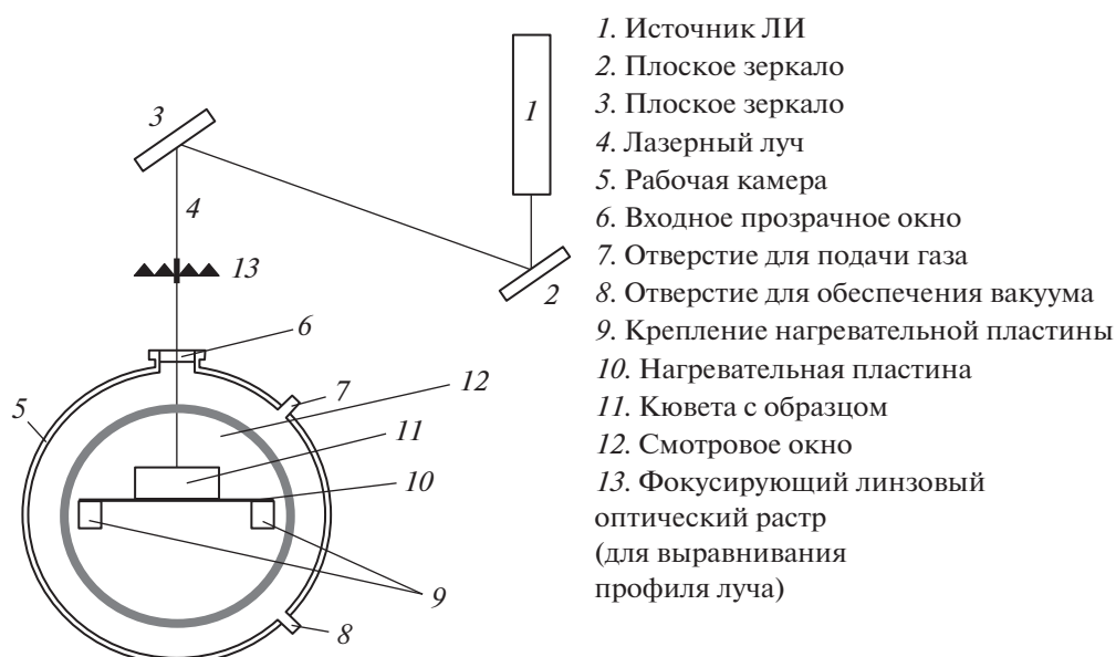
Рис. 1. Схема экспериментальной установки.
