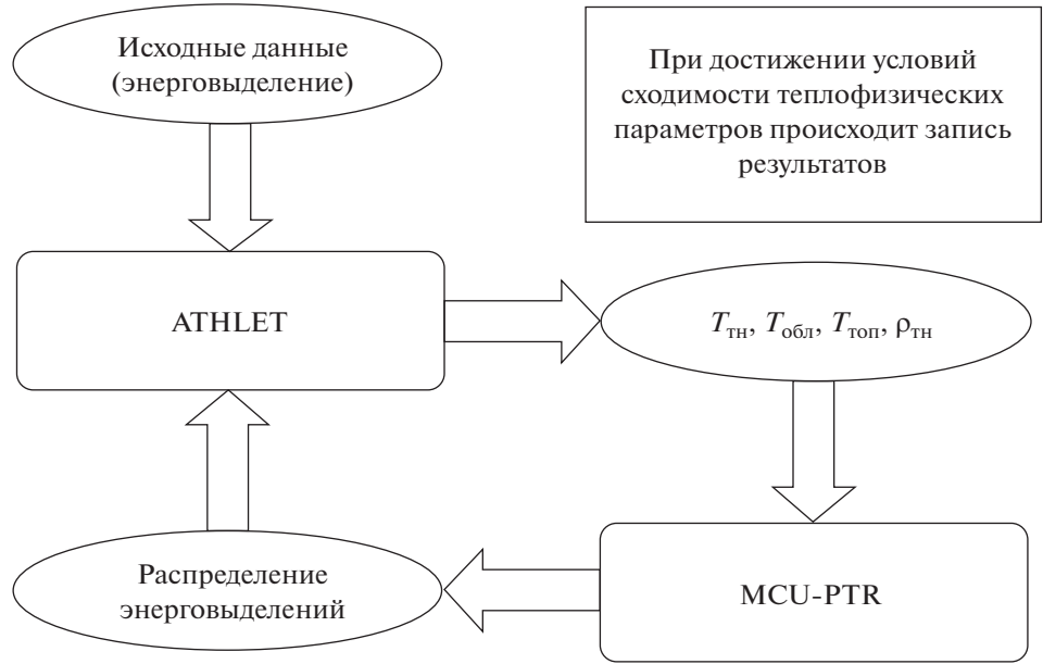
Рис. 1. Схема осуществления обратной связи между кодами описание математической модели шеститрубной ТВС ИРТ-3М в программе MCU-PTR.
