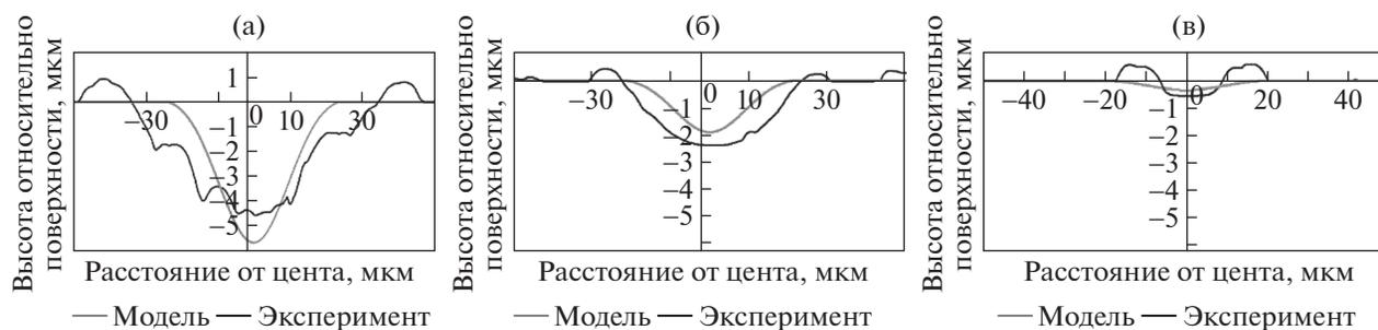
Рис. 9. Профиль кратеров теоретический и экспериментальный для (а) 200, (б) 50, (в) 4 нс.
