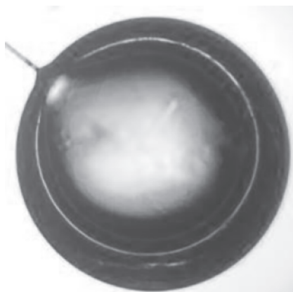
Рис. 5. Влияние стеклянного капилляра на однородность слоя.
