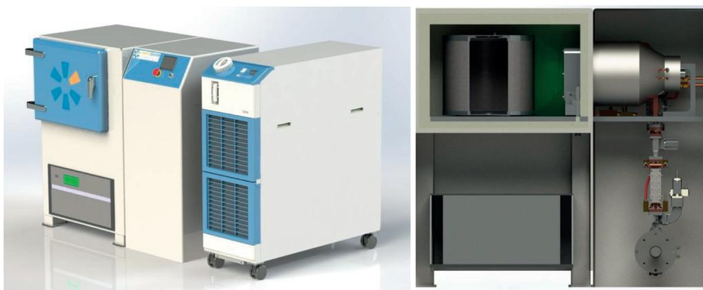
**Рис. 1.** Концептуальный рендеринг системы облучения ТСН на основе линейного ускорителя: внешний вид (слева) и внутреннее содержание (справа).
